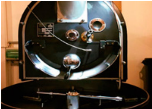
Figura 7: Tostadora de 12 kg de capacidad
