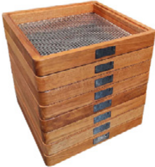
Figura 19: Juego de mallas (Tamices) de clasificación de café
