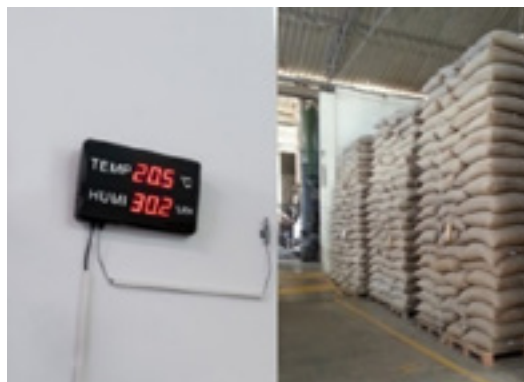
Figura 30: Medidor de temperatura y humedad del almacén
